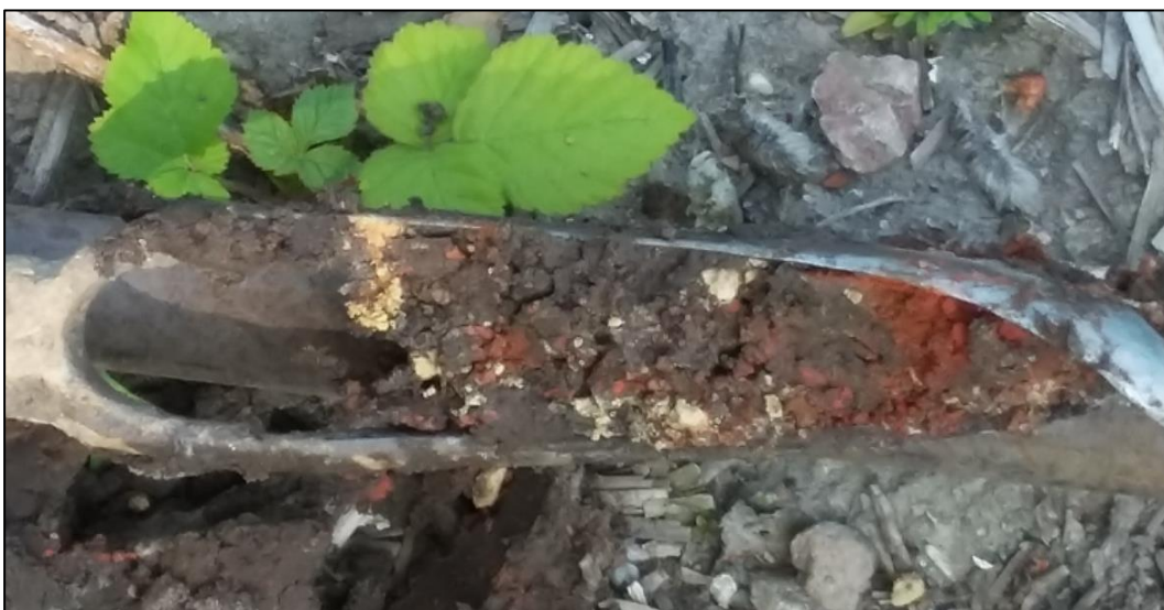
Afbeelding 20. Foto van boring 12 op een diepte van circa 0,4-0,5 m-mv, met zeer puinhoudende steigeraarde
